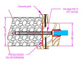
Dans le cas des Châssis ouvrants et châssis grand écran, l'épaisseur mini de la paroie béton est de 100 mm
