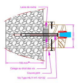
Cas du montage à l'avancement dans cloisons de carreaux de plâtre **uniquement** avec feuillure à brique (calfeutrement = 0 mm)
