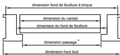
\*: ne pas confondre avec la dimension de passage porte(s) ouverte(s) à 90°
